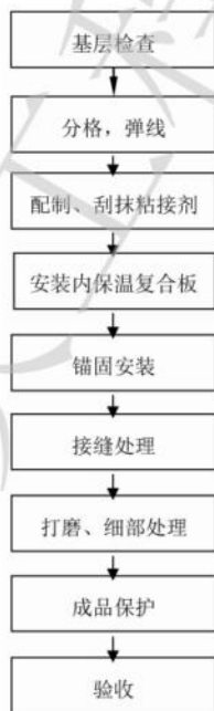
图 6.2.1 建筑外墙内保温系统施工工序
